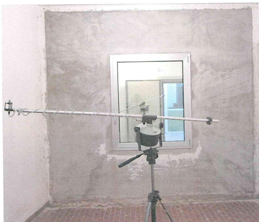
Figura 6 – Campione in prova: lato ricevente.
