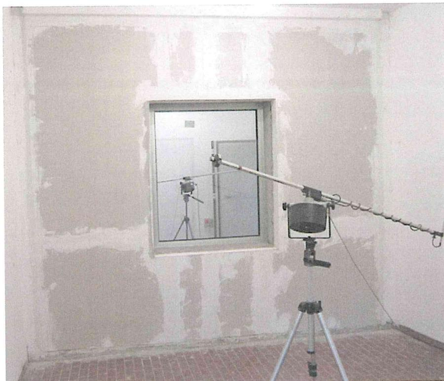
Figura 5 – Campione in prova: lato sorgente.
