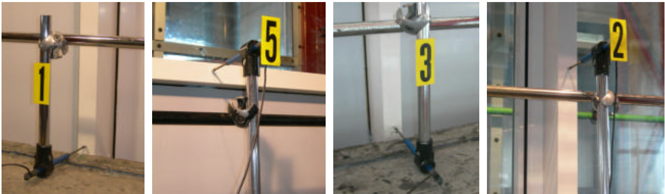
Foto 7, 8, 9 e 10: Dettagli delle prove di resistenza al vento condotte sul campione (prova di deformazione)
